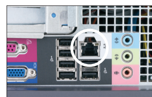
Port Ethernet sur le panneau arrière du CPU de l'ordinateur de la IDEXX VetLab Station
